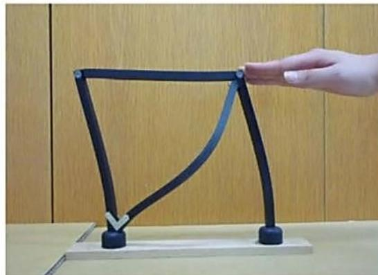
筋かいの座屈を間柱などで防止することが、耐力を発揮させるポイント
