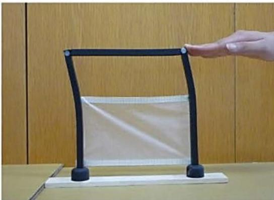
壁で拘束されていない部分の柱が大きく曲げ変形している(天井や床下に壁がないと、抵抗力が小さい)
