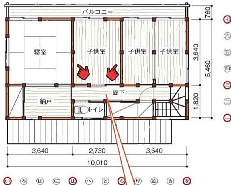
2階は、壁量が外周壁のみで足りる場合でも、屋根面の水平剛性不足から壁量を増やす場合がある。水平力に対して建物の中央部分が大きく変形しそうな場合には、建物の中央付近に耐力壁を配置する
